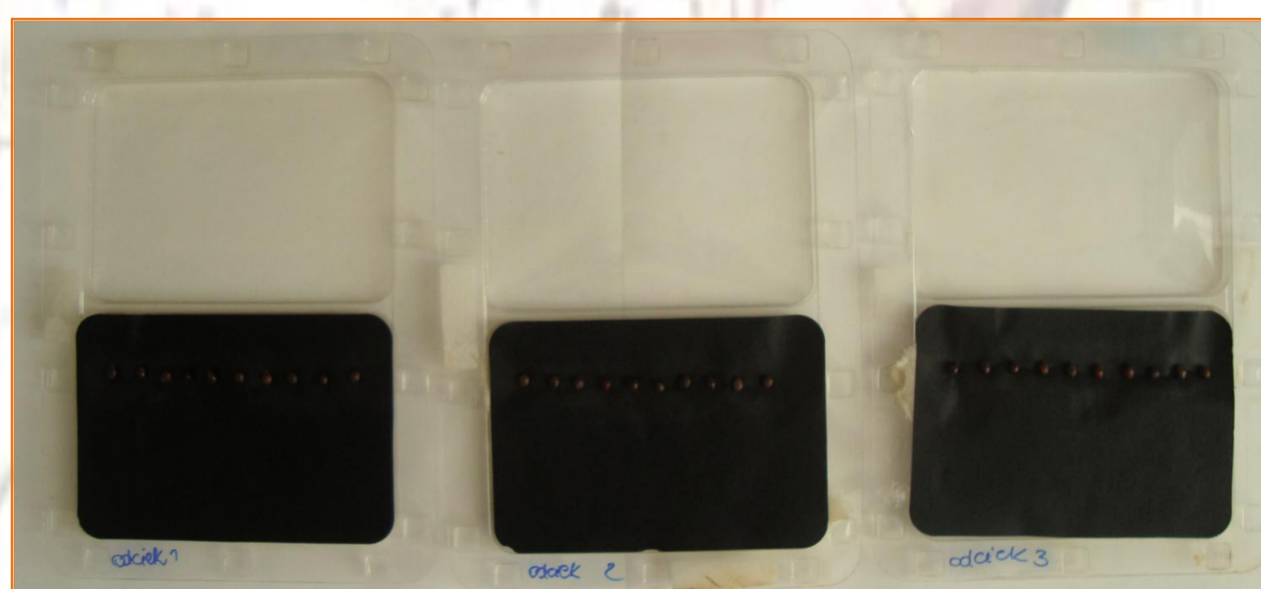
Rysunek 3. Płytki testowe z nasionami Sorgo saccharatum po 72-godzinnej inkubacji
